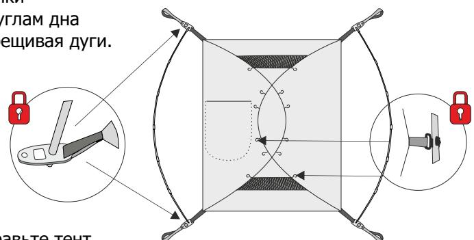
4. Зафиксируйте на дугах пластиковые крючки пришитые на внутренней палатке.
