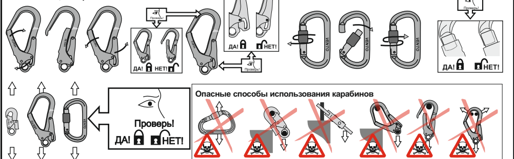
Рис. 7. Способы крепления стропов к анкерным устройствам
