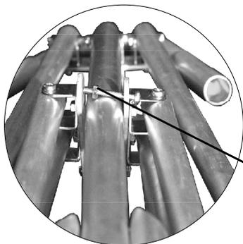
2. Перевести носовой штевневой узел из транспортировочного положения в рабочее, для чего вставить винт в отверстие трубы и затянуть.
